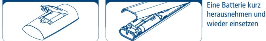
Eine Batterie kurz herausnehmen und wieder einsetzen
