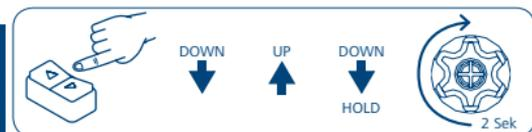
Die Tasten schnell hintereinander folgend drücken, und bei dem mit "HOLD" gekennzeichneten dritten Schritt die Taste gedrückt halten, bis die Bestätigungsbewegung des Motors durchgeführt wird.
