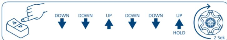
Dass eine oder beide Endlagen gelöscht wurden erkennt man daran, dass beim Drücken der Taste sich der Motor kurz bewegt, kurz stoppt, bevor er sich erneut bewegt.
