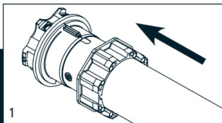
1. Den Adapter komplett auf die Nut des Endanschlagrings am Motor aufschieben.
