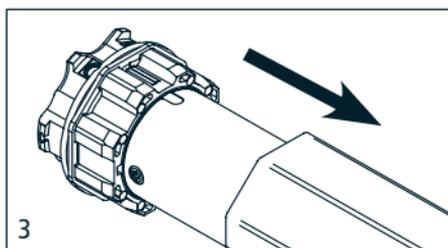
3. Den Motor vollständig in die Rolladenwelle einschieben.
